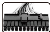
24针主电源接头 (部分机型提供4针模块可分离式设计): 用于主板电力输出与开关控制。
